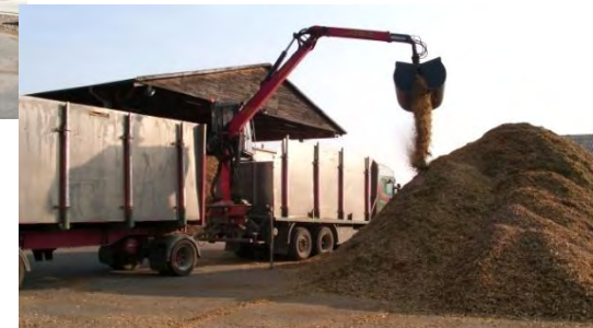
umgebauter Kurzholz- transporter: 70 m 3
